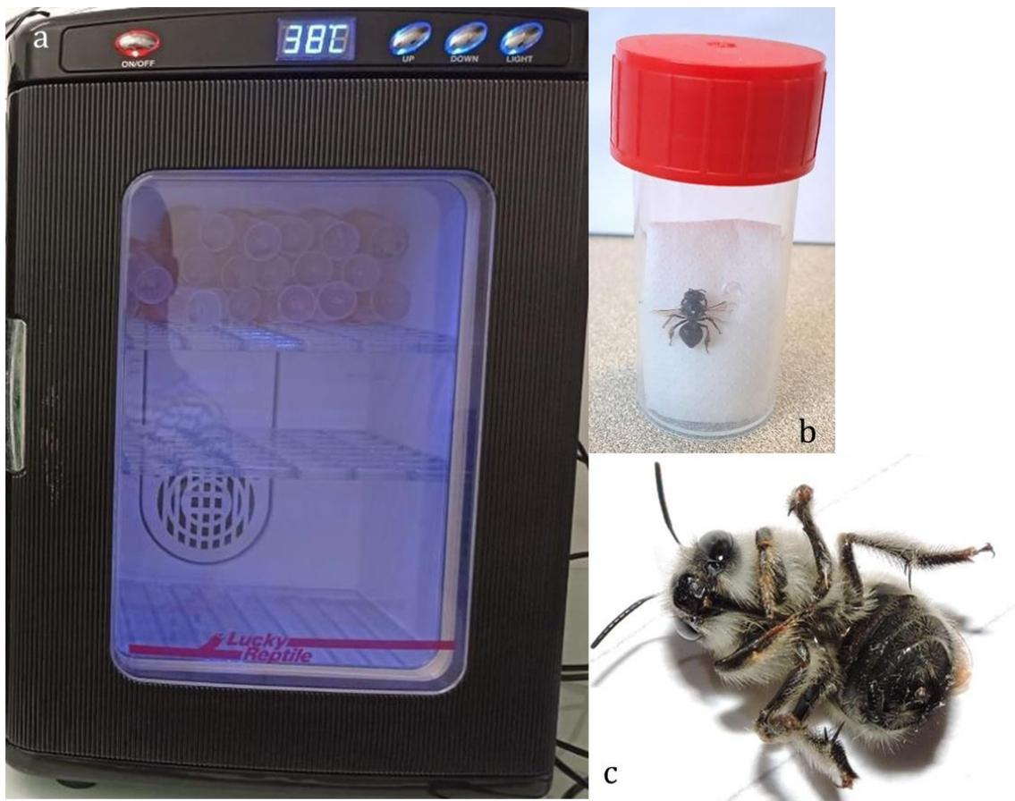
**Figure 14 :** Incubateur Herp Nursery utilisée pour l'expérience du THS (a), tube de 40 ml avec un papier à l'intérieur (b) et abeille en stupeur thermique (c). Photos prises par Mira Boustani
