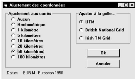
**Figure 16. Fenêtre de dialogue du menu "Ajustement des coordonnées" "UTM-British Grid-Irish Grid". L'option choisie ici est un ajustement sur une grille UTM à mailles de 50 km de côtés.**
