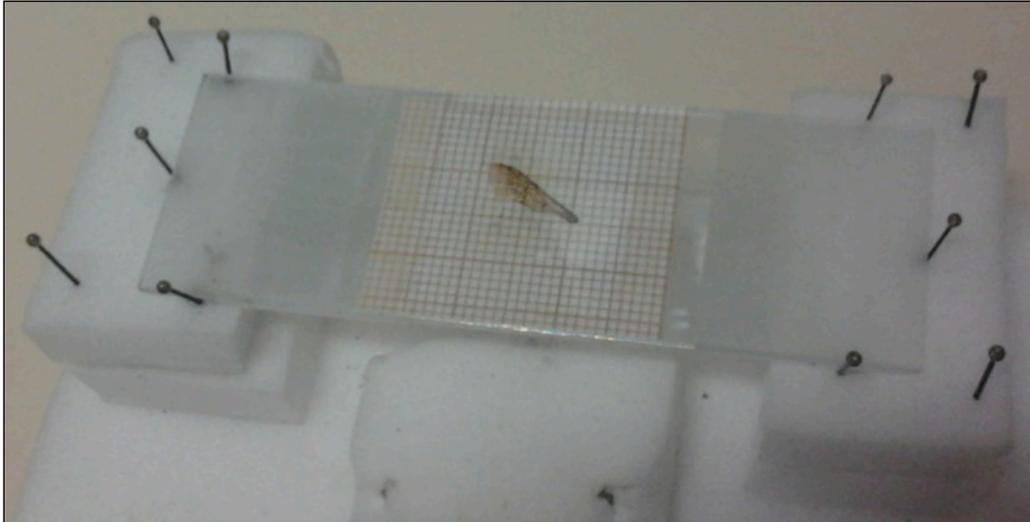
**Figure 14** : Placement des deux lames sur le support en mousse (Photographie : D. Michez).
