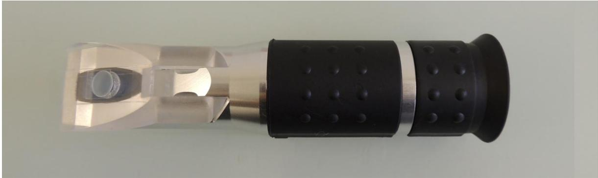
**Figure 11:** réfractomètre Bellingham & Stanley, modèle: Eclipse Professional 45-80°Brix
